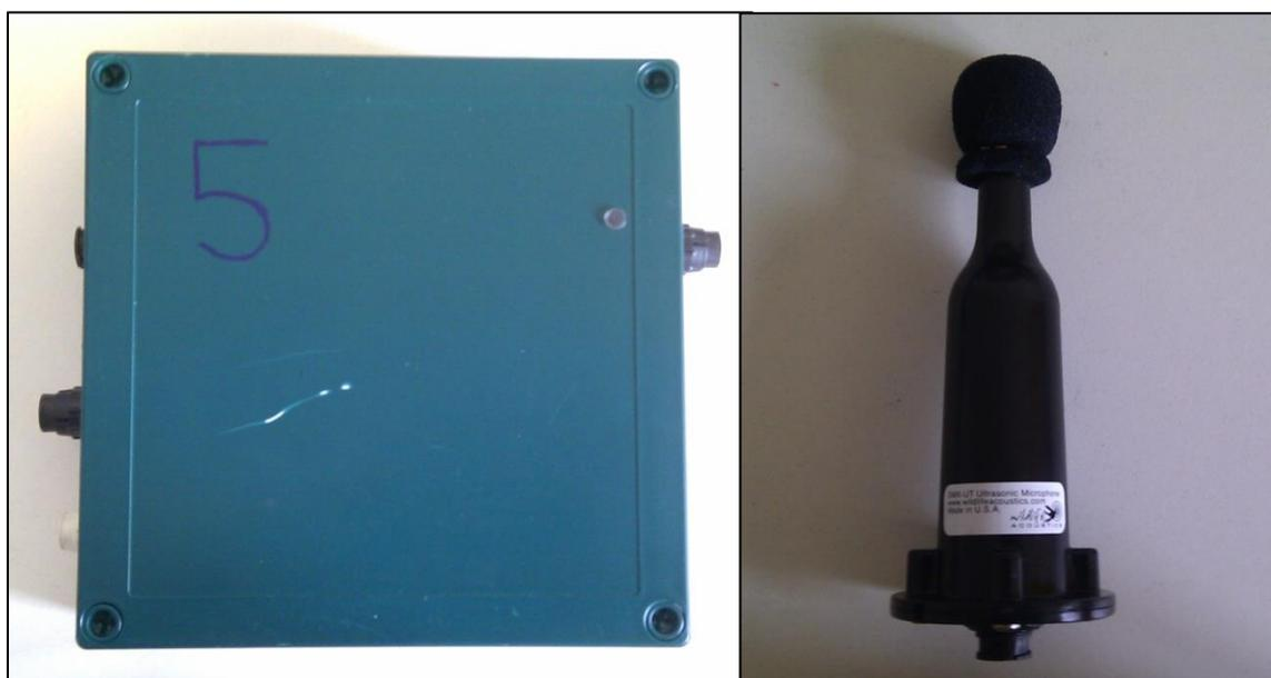
Figure 1 : Enregistreur autonome SM2BAT+ et microphone.
